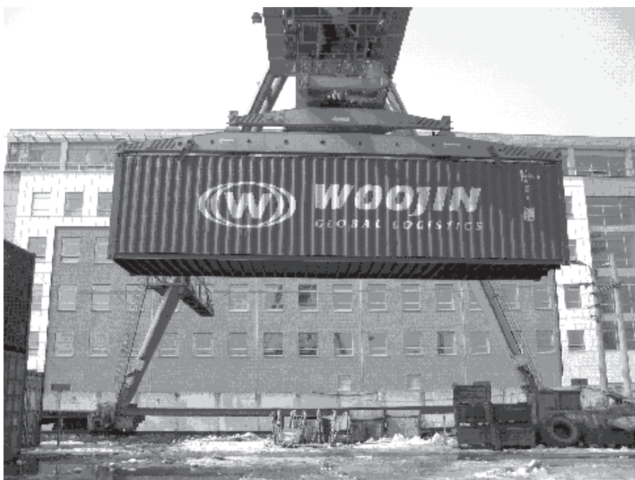
Рис. 1.4. Козловой контейнерный кран со спредером
